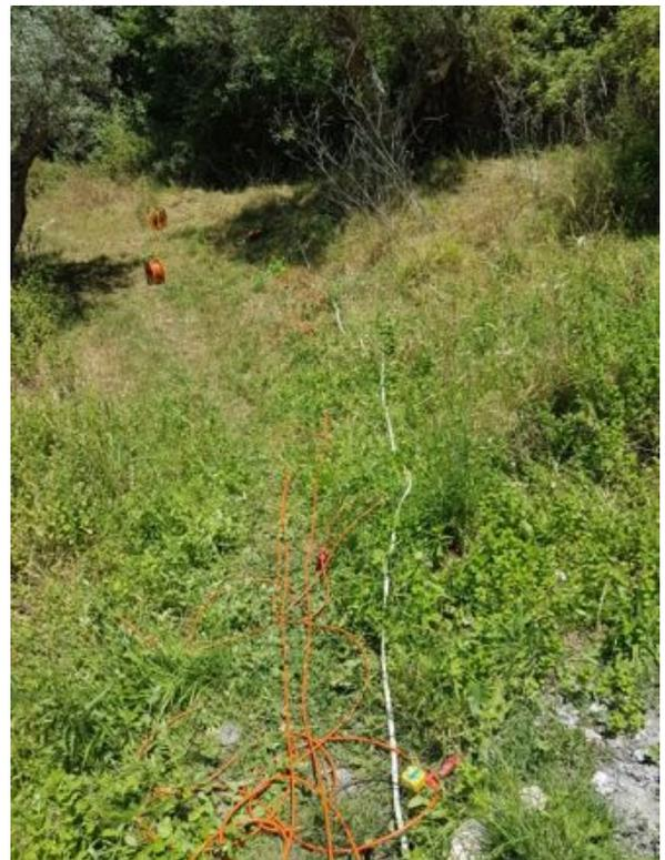
ANALISI SISMICA A RIFRAZIONE
