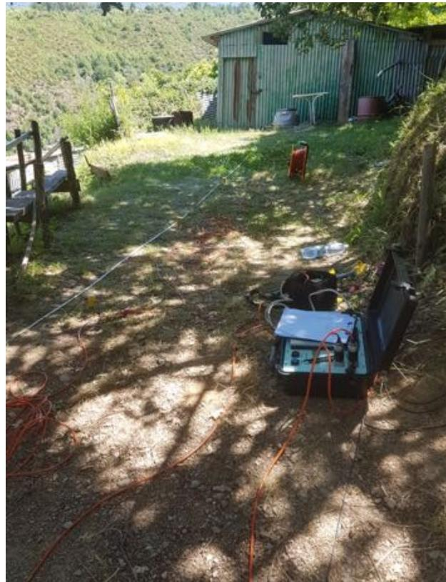
ANALISI SISMICA A RIFRAZIONE
